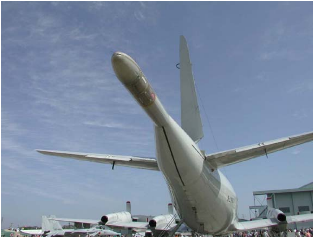
Figura 2: MAD de un P-3 Orion
