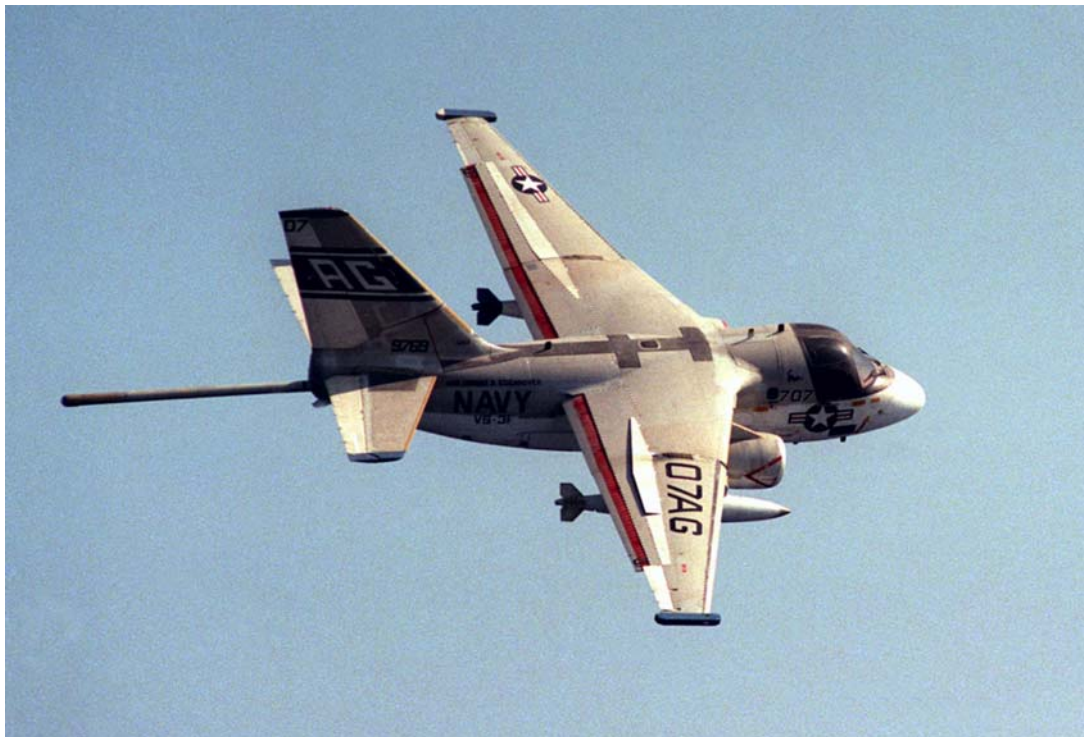
Figura 3: MAD extendido de un S-3A Viking.
